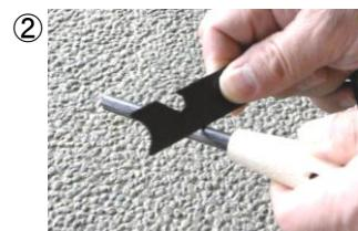
②ブレードを強く速くスライドさせて火花を飛ばし、マグネシウムの粉末に当てる着火する。（写真③）
