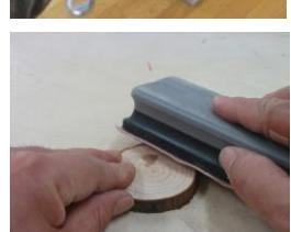
マジックテープが付いている面に、ヤスリを貼り付けて使用する。
